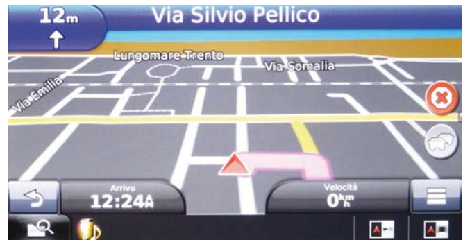
Una schermata del navigatore nella sua versione "standard". È comunque possibile personalizzare i parametri che compaiono sullo schermo ma anche la composizione della schermata, come si vede dalle icone in basso a destra.
